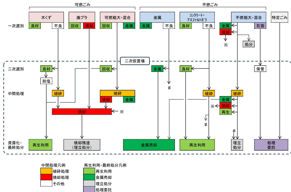
図 6-5 災害廃棄物の処理フロー（例）
