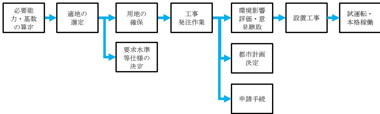
図 6-7 仮設焼却炉等の設置フロー
