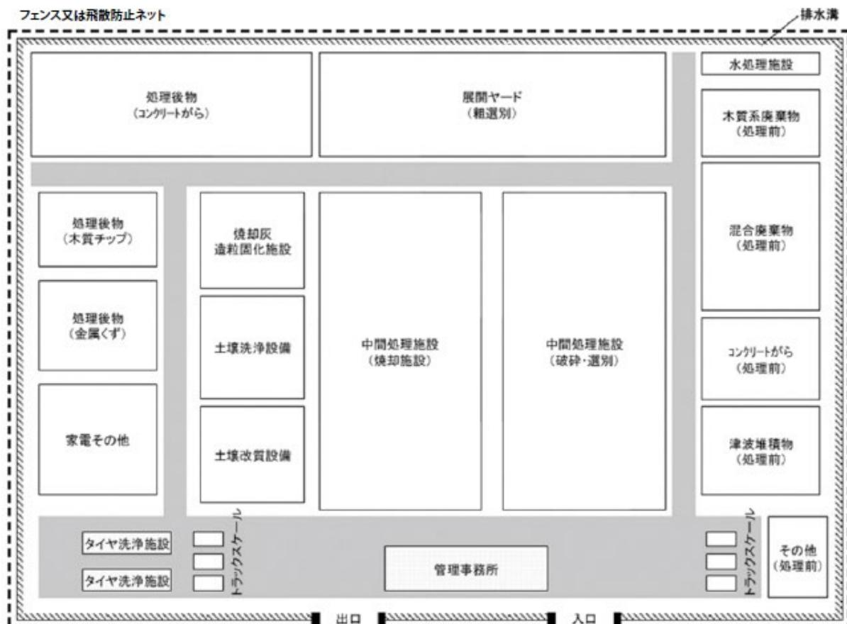
図 6-4 仮設焼却炉・破碎機等を含む二次仮置場のレイアウト例
