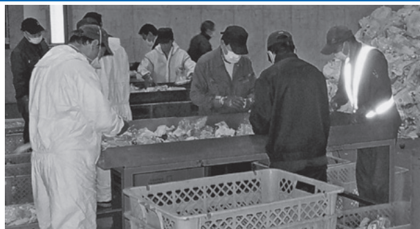
プラスチックごみに混入している異物を手作業で取り除いています。
