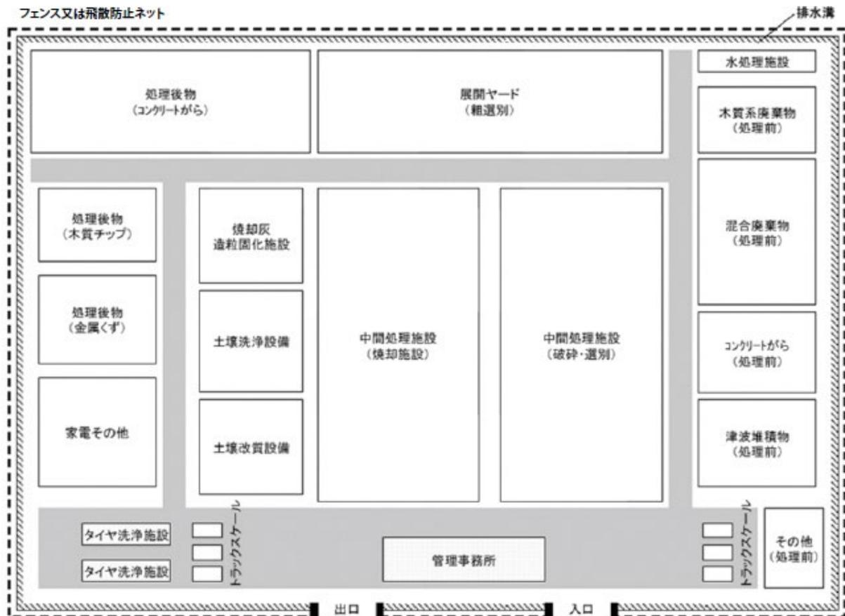
図 6-4 仮設焼却炉・破砕機等を含む二次仮置場のレイアウト例
